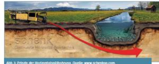
Abb. 3: Prinzip der Horizontalspülbohrung. Quelle: www.schenkag.com.
