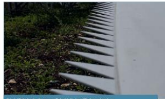
Abb. 3 Hinterkantenkämme am Rotorblatt einer Windenergieanlage. Der Hinterkantenkamm reduziert den Schall durch Verwirbelung. Quelle: Emmeo SA.
