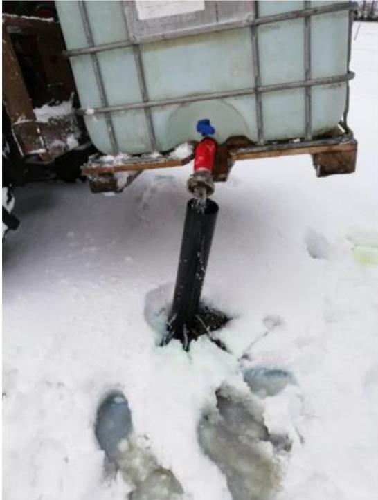
Abbildung 9: Versuchsaufbau einer Impfstelle mit Piezometerrohr und Wassertank.
