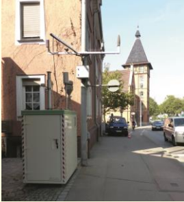
Messtation der LUBW zur Erfassung von Straßenverkehrslärm in Reutlingen, Foto: LUBW
