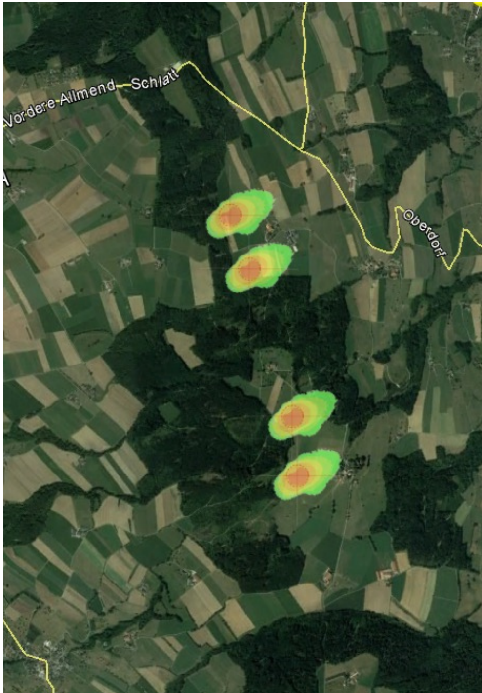
Abbildung 10: Resultate Eisfall der maschinen- und standortabhängigen Neuberechnung auf Basis der Standortwahl zur 1. Vorprüfung beim Kanton (hier ohne Berücksichtigung der Anlage Müswangen).
